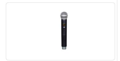
Trasmettitore palmare adatto all'utilizzo in abbinamento a radiomicrofoni della serie SET 8300/8302. Frequenza operativa A: da 663.100 MHz a 677.400 MHz Impiega 2 batterie AA - 1,5V (non incluse)
