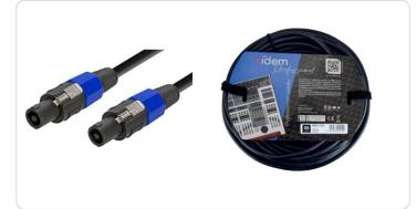
Cavo audio professionale con connettori speakon per il collegamento rapido di diffusori e amplificatori. Il cavo Ã" composto da 2 conduttori da 1,5mm² e ha un diametro esterno di 7 mm e presenta schermatura per la massima resa. La lunghezza Ã" di 10mt
