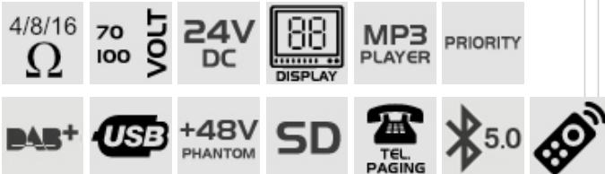
Amplificatore destinato ad impianti di filodiffusione. Incorpora un modulo Mp3 in grado di leggere brani da USB/SD, una ricevente bluetooth e un aggiornatissimo modulo radio FM/DAB+. Consente il collegamento di diffusori sia a tensione costante che ad impedenza per un massimo di 240W. Dispone di 3 ingressi microfonici e 4 ingressi di linea. L'ingresso MIC1 A" di tipo >XLR e supporta alimentazione phantom +48V per microfoni a condensatore.
