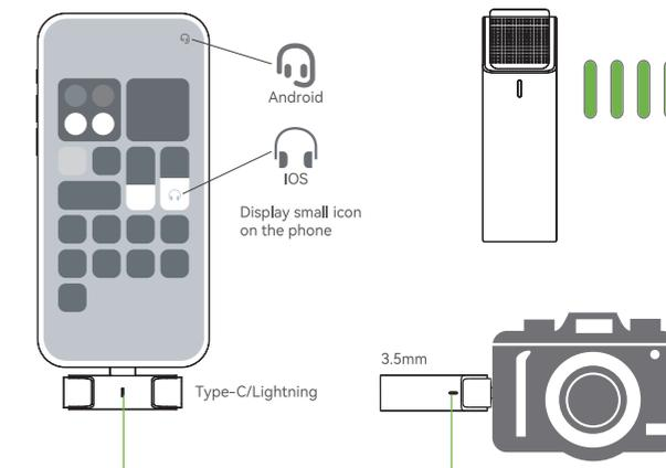
Led lampeggianti indicano che microfono e ricevente non sono connessi.
