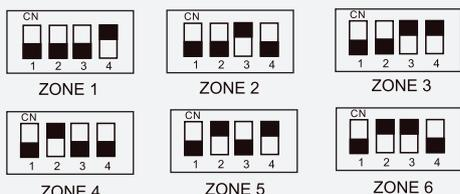
I dipswitch all'interno del PWC 2 sono impostati di fabbrica per collegare la zona 1 dell'amplificatore. Se desiderate usare una zona diversa aprite il PWC 2 e settate i dipswitch in base a questo schema.
