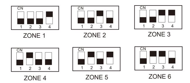
Lo schema mostra come devono essere impostati i dipswitch posti all'interno del PWC 2 a seconda della zona dell'amplificatore che viene utilizzata. L'impostazione di fabbrica è quella corrispondente alla zona 1. Se si desidera utilizzare una zona diversa è necessario smontare il PWC 2 e modificare le impostazioni dei dipswitch.
