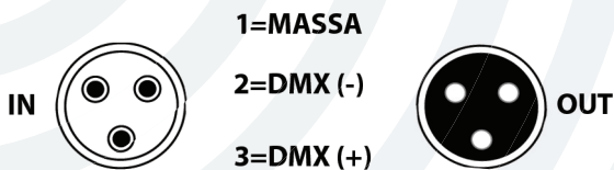
Configurazione connettore DMX
