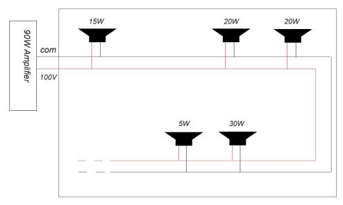
**ESEMPIO:** All'impianto sono stati collegati 5 diffusori per un totale di 90W. L'amplificatore gestisce fino a 110W per cui in futuro potranno essere collegati altri diffusori fino a saturare la potenza dell'amplificatore.
