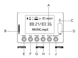
Questo pannello di comando permette di gestire tracce audio tramite chiavette USB, schede microSD, bluetooth o direttamente dalla radio FM. L'ampio display (A) consente di visualizzare le informazioni operative.
