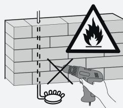
**ATTENZIONE:** prima di effettuare qualunque foro, verificate che non vi siano tubi, cavi elettrici o linee del gas all'interno del muro. Nel dubbio utilizzate un dispositivo elettronico denominato "cercatubo".
