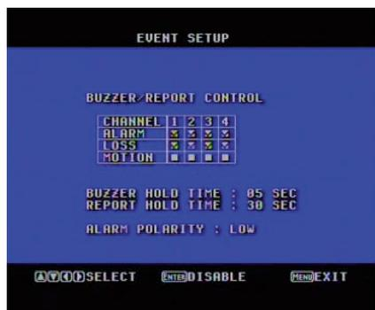
Spostate il cursore per entrare nella finestra di “event setup” (programmazione evento). L’utente può modificare il valore dei parametri: “buzzer hold time” (durata suoneria), “report hold time” (durata evento allarme), “alarm polarity” (polarità allarme).
