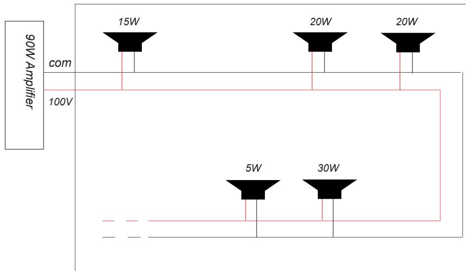
**ESEMPIO:** All'impianto sono stati collegati 5 diffusori per un totale di 90W. L'amplificatore gestisce fino a 110W per cui in futuro potranno essere collegati altri diffusori fino a saturare la potenza dell'amplificatore.
